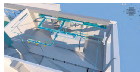
F3 — Вид помещения электрощитовой объекта (ближняя стена скрыта для лучшей видимости)
