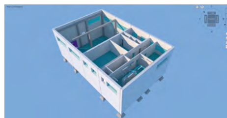
F2 — Общий вид объекта сверху, в дальней (левой) части изображения виден основной зал объекта, а в ближней (правой) части помещения — электрощитовая объекта, которая представлена на изображениях P3 и F3)
