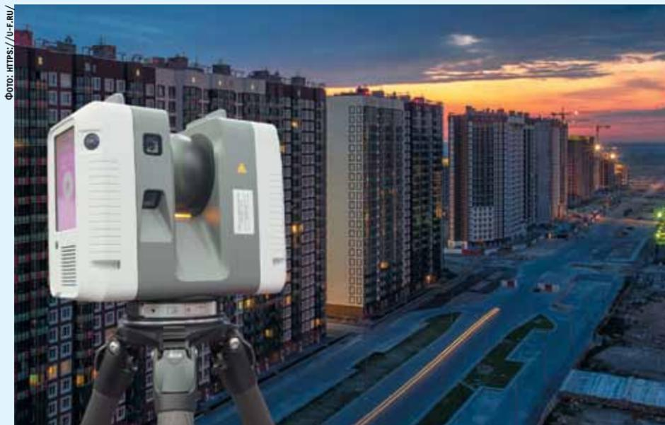
земное лазерное сканирование, в связи с универсальностью и простотой метода, разнообразием и более низкой ценой оборудования. Оно наиболее активно используется в строительстве (строительный контроль, авторский надзор), ведении маркшейдерских работ (подсчет объемов, регулярные замеры и съемки), осуществлении реконструкции геометрически сложных объектов наследия.
