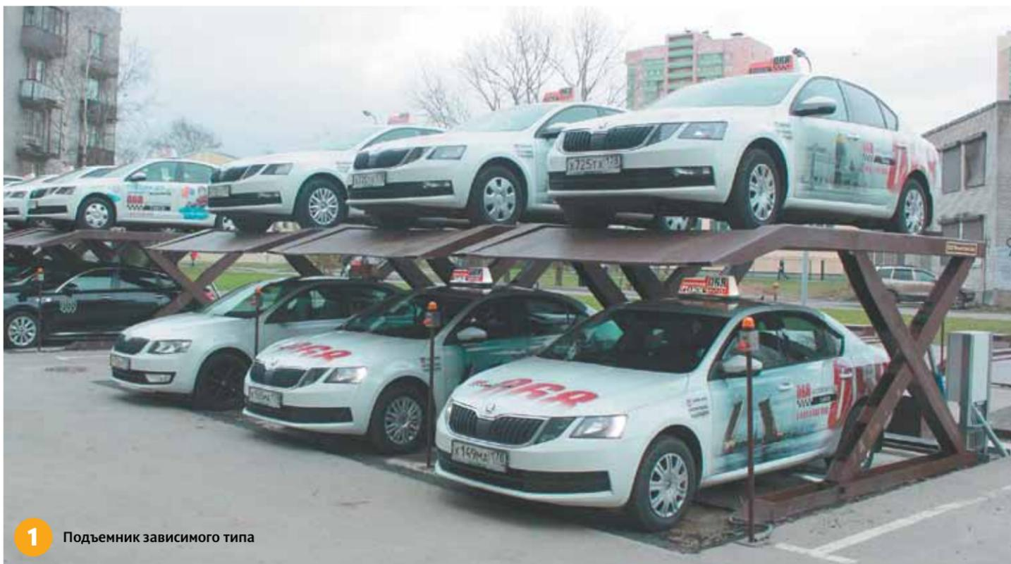
1 Подъемник зависимого типа
