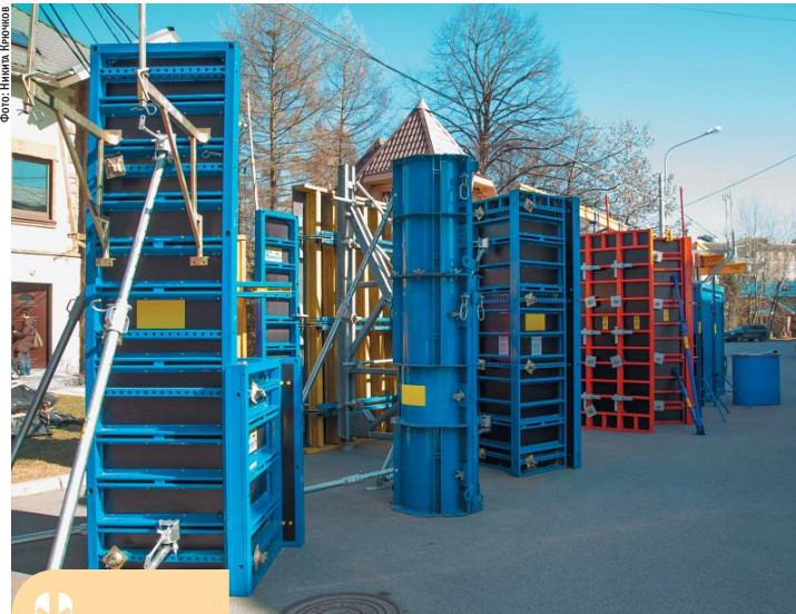
Производители рекомендуют уделить внимание качеству арендуемых опалубочных систем, от которого зависит и качество бетонных конструкций
