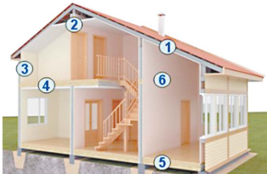
→ Дом из ПСК в разрезе: 1. Конструкция крыши. 2. Панель покрытия. 3. Панель стеновая. 4. Панель перекрытия. 5. Панель основания. 6. Внутренние перегородки
