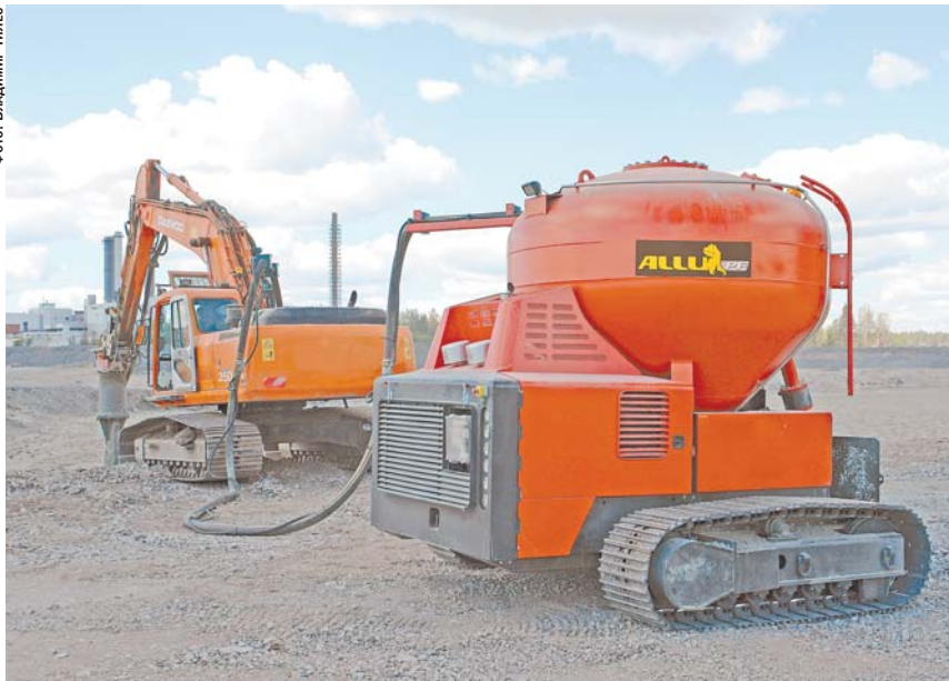
Иновационная техника ALLU (Финляндия) позволяет стабилизировать слабые грунты на глубину до 5 метров
