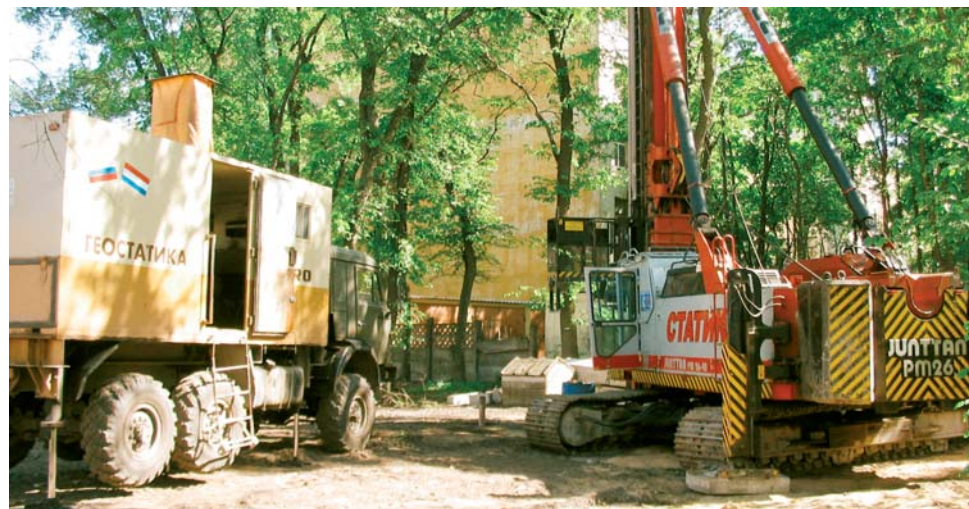
Установка для статического зондирования на базе автомобиля КамАЗ 43114 (слева) и буровая установка Junttan PM 26-40 (справа)
