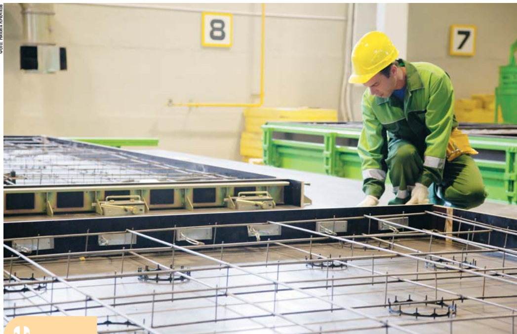
Новая технологическая линия на Гатчинском ССК – это 10 поворотных столов для производства панелей любых форм и текстурной поверхности
